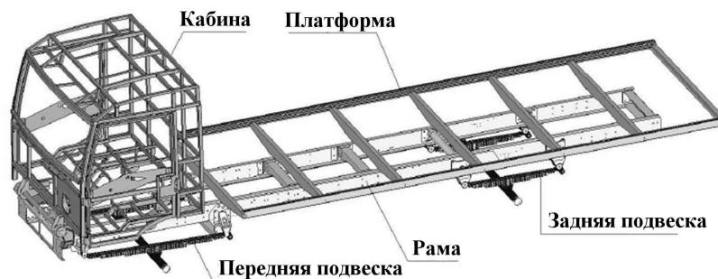
Рис. 3. Подробная модель комплектного грузового автомобиля
