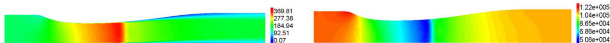
Рис. 13. Задача 3. Распределение скорости и статического давления в диффузоре для режима слабый скачок ; модель турбулентности SST
