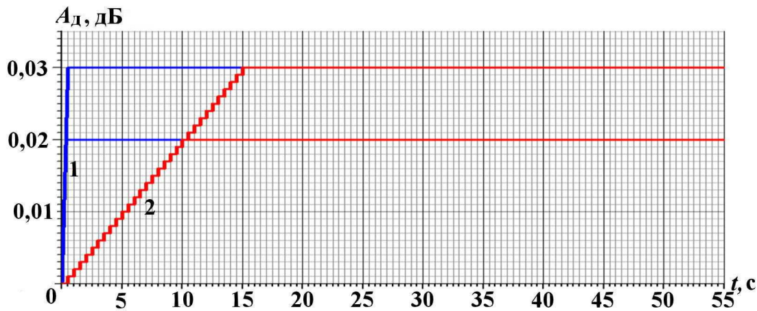
Рис. 12. Формы и параметры испытательных сигналов, задаваемых аттенуатором: 1 — быстрый вывод; 2 — плавный вывод
