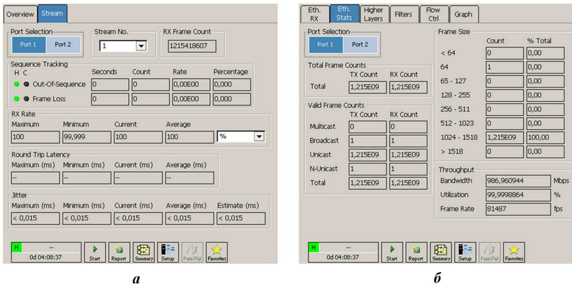
Рис. 10. Окна анализа потока и статистики переданных/принятых кадров (а) и производительности (б) для порта 1 за время теста 2
