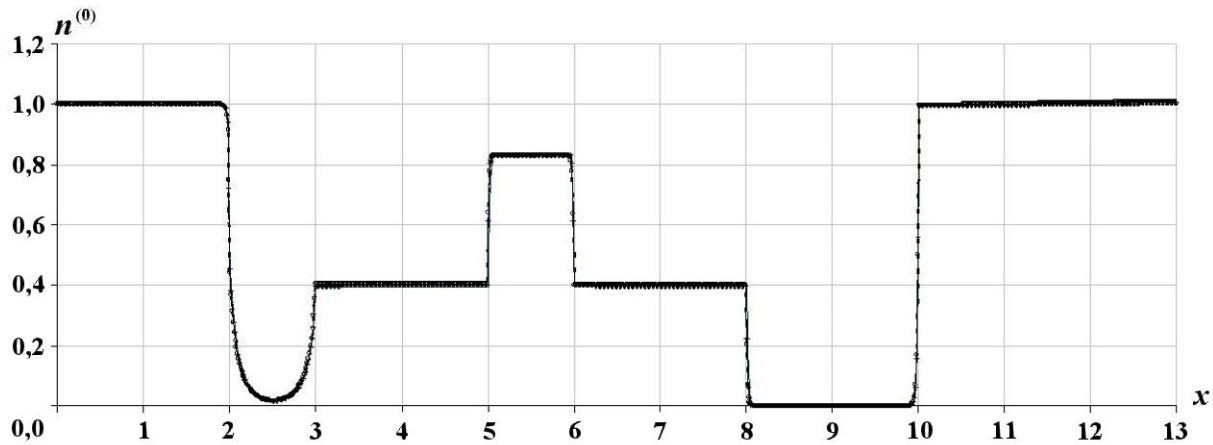
Рис. 16. Расчетные профили плотности потока частиц для семиобластной задачи на сетке с шагом 0,0125: -+- - DD-схема; — — St-схема; -o- - TFS, 256 разбиений; - - - - TFS, предельный случай
