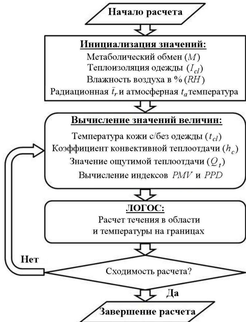
Рис. 1. Блок-схема алгоритма метода TCM
