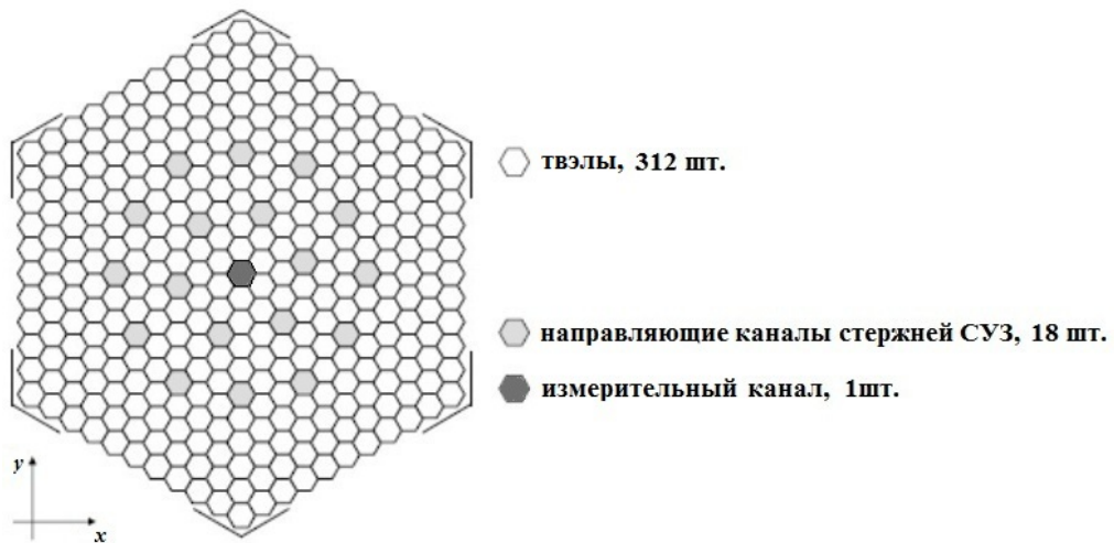
Рис. 3. ТВС типов А13 и А20 с обогащением 1,3 и 2,0% по ^{235}\text{U} соответственно
