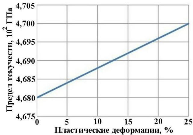
Рис. 19. Зависимость предела текучести от пластических деформаций
