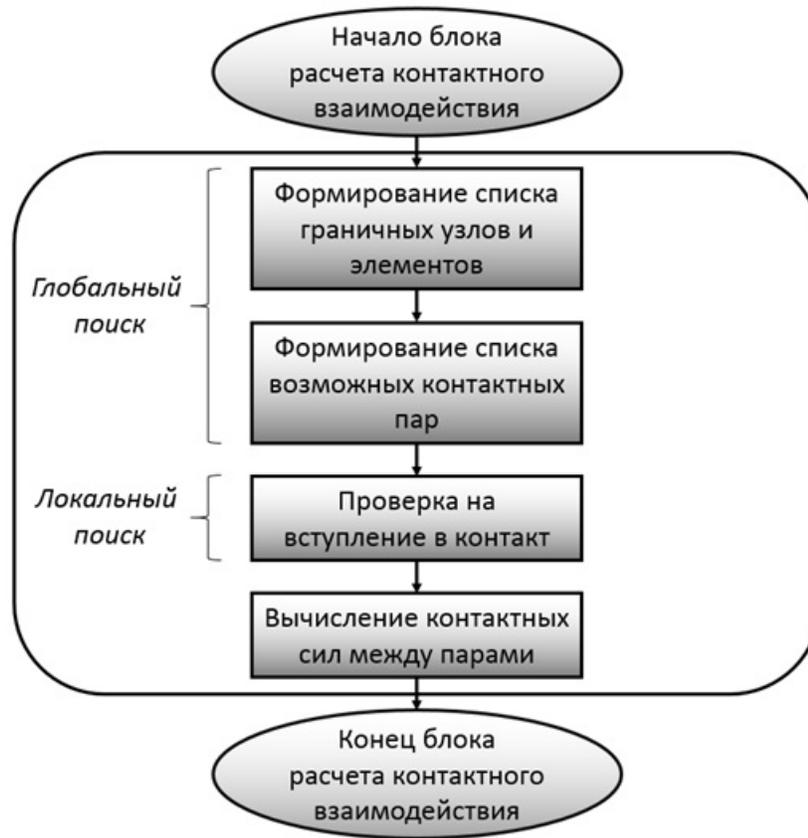
Рис. 1. Общая схема расчета контактного взаимодействия
