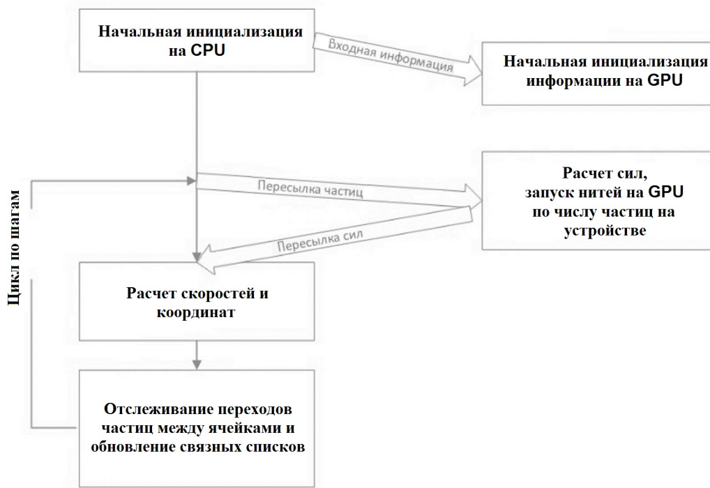
Рис. 1. Схема счетного шага с использованием GPU
