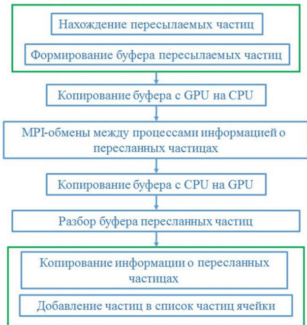
Рис. 2. Алгоритм пересылки частиц на другой MPI-процесс
