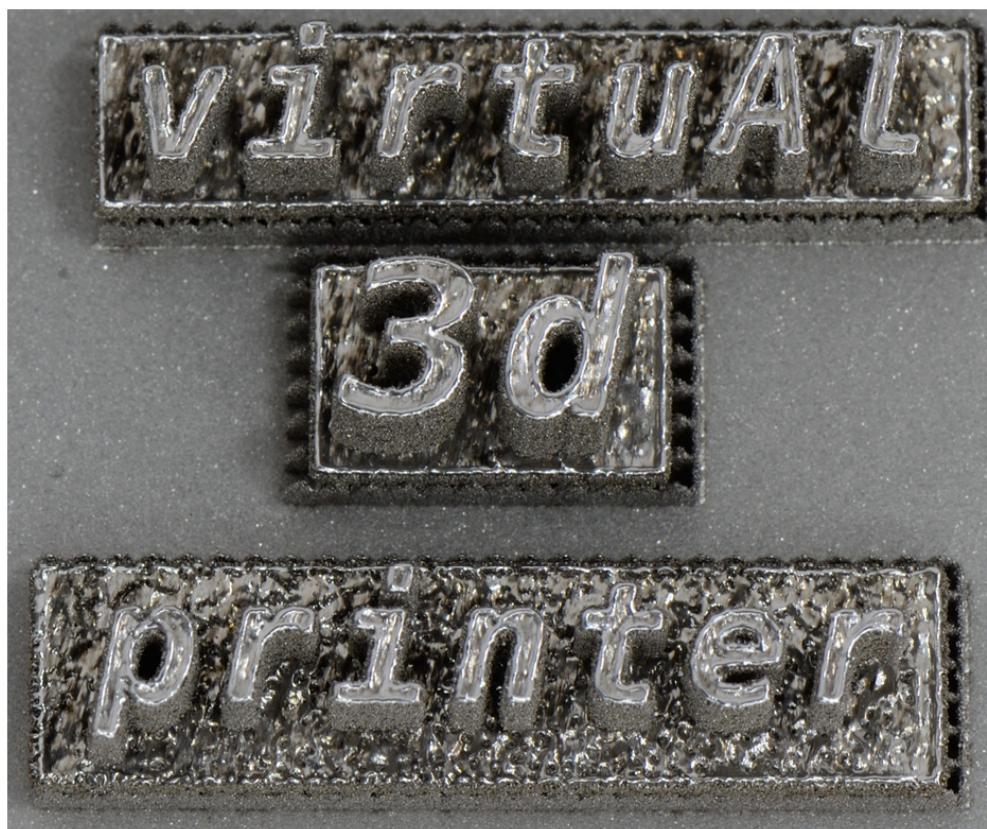
Рис. 15. Фотография выполненной векторным шрифтом надписи, полученной селективным лазерным спеканием металлической порошковой смеси
