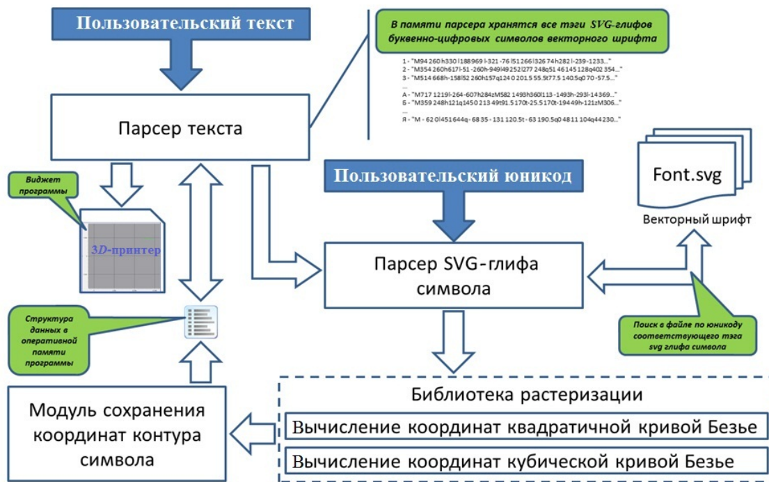
Рис. 7. Схема работы программ поддержки векторных шрифтов в модуле задания 2D-контуров
