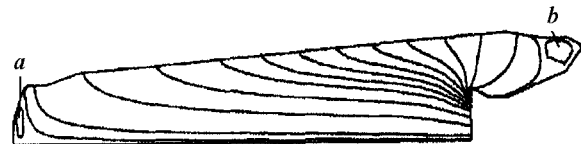
Рис. 4. Камера сгорания конусной формы и линии тока газа в ней. Замкнутые вихревые потоки в зонах переднего (а) и заднего (b) днищ камеры
