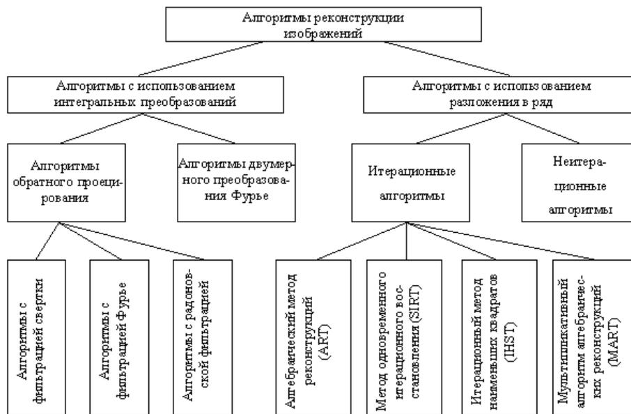
Рис. 1. Классификация методов реконструкции изображений по проекциям
