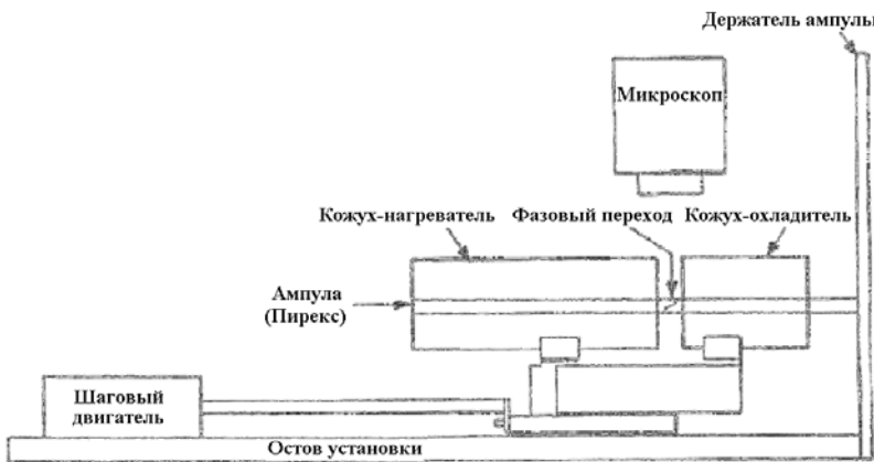
Рис. 9. Схема установки Бриджмена
