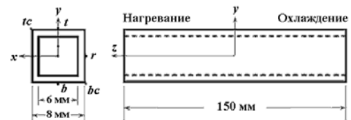
Рис. 10. Геометрия ампулы с кристаллизующимся материалом
