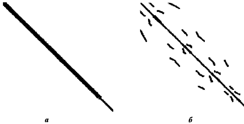
Рис. 21. Структура матрицы: a — скалярный режим; b — параллельный режим (4 процессора, одномерная декомпозиция полосы )
