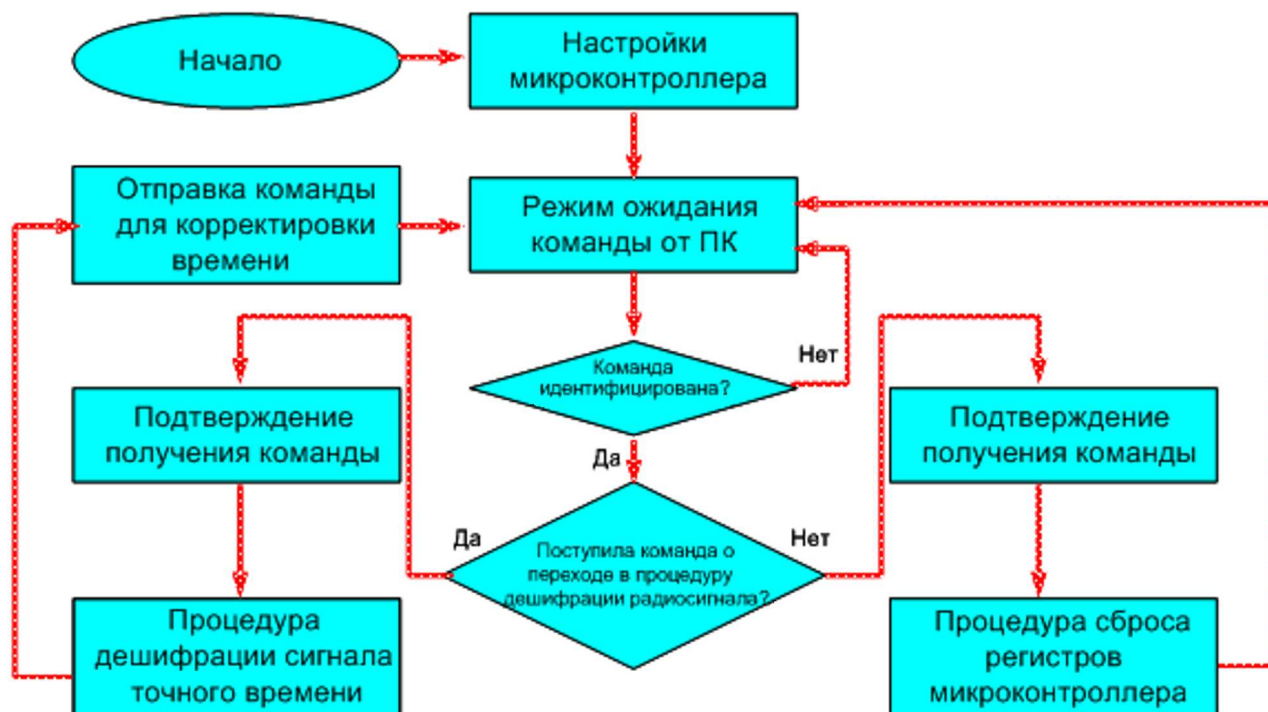
Рис. 3. Блок-схема алгоритма работы управляющей программы ВСТВ
