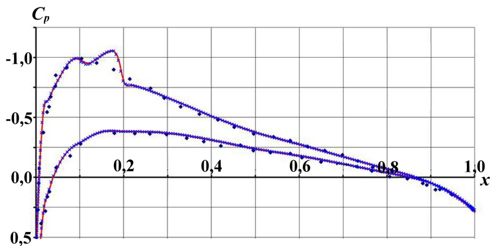
Рис. 13. Задача 3, тест 2. Распределение коэффициента давления C_p по верхней и нижней поверхностям профиля, \alpha = 1,49^\circ : \blacklozenge — эксперимент; — — FLUENT; \times — схема ГКР
