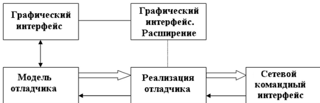
Рис. 3. Архитектура центрального компонента отладчика: \Rightarrow — внутренние команды; \leftarrow — асинхронные сообщения
