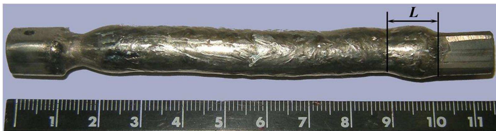
Рис. 2. Перекристаллизированный методом БЗП образец TiAl (Nb, Cr, Zr)
