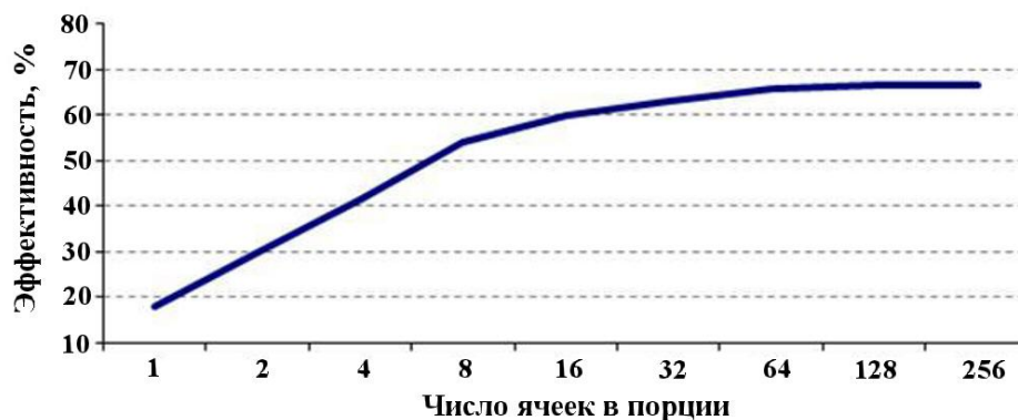
Рис. 1. Зависимость эффективности OpenMP-распараллеливания от числа ячеек в порции (16 потоков)
